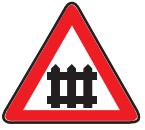
T-25 Kontrollü Demiryolu Geçidi
